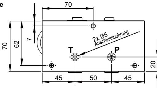
Die Gegenflächen der Flanschanschlüsse müssen eine Oberflächenrauigkeit von mindestens  $Ra = 1,6$  aufweisen.
