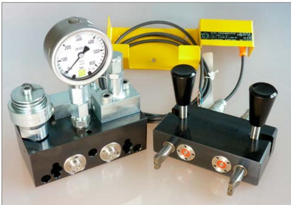
Doppelt wirkende Kupplungsnippeleinheit mit 13 cm<sup>3</sup> Hydraulikspeicher (l.), Kupplungsmechanikleiste (r.) und Sicherheitsaufnahme für Kupplungsmechanikleiste mit induktivem Näherungsschalter (h.).
